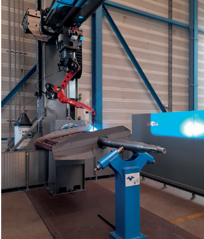
Binnenvaartroeren worden computergestuurd gedraaid en gelijktijdig volautomatisch gelast door een robot die van bovenaf werkt.
