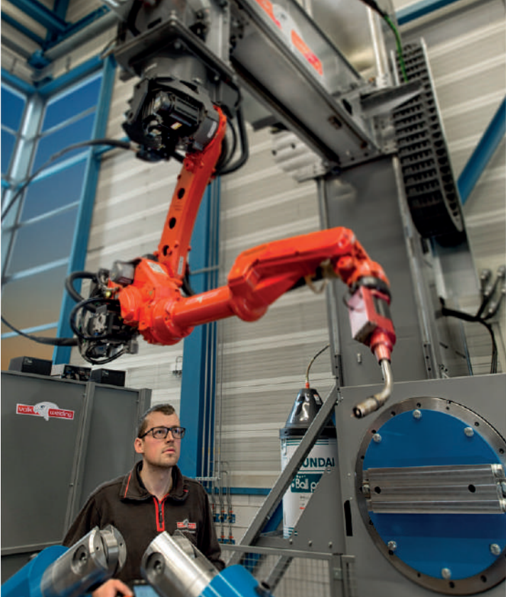
De grote robotinstallatie met op de achtergrond de draaischijf waarmee roeren horizontaal worden opgespannen en volautomatisch worden gelast.
