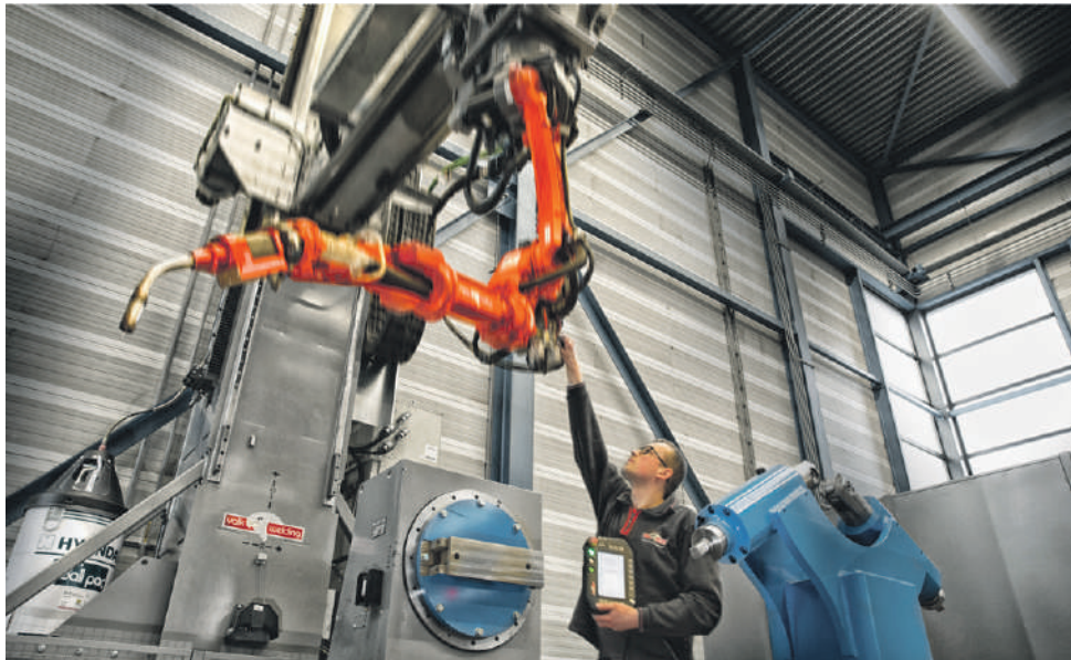
Bij De Waal worden roeren en roeronderdelen volautomatisch door een robot gelast.
