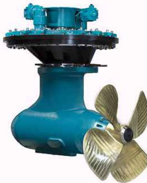
De elektromotor bevindt zich onder water in het huis waar een directe aandrijving op de schroef tot stand komt.
