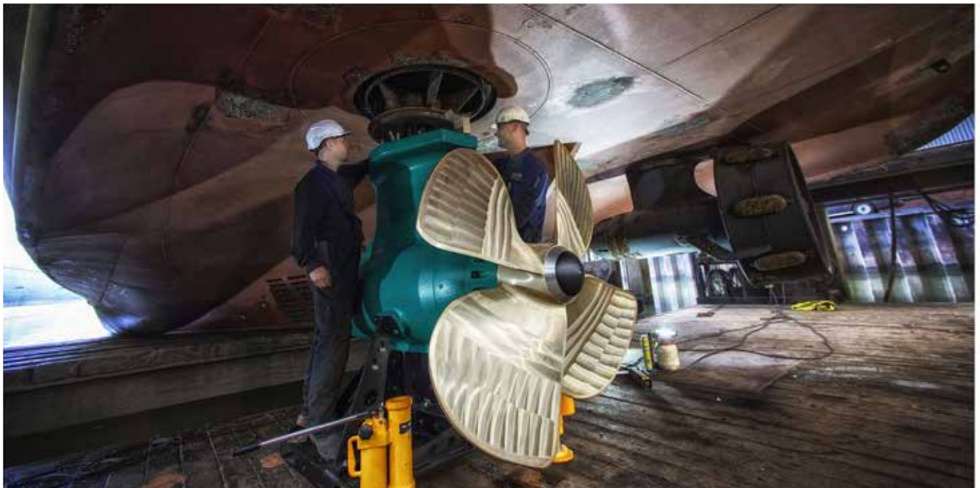
Het plaatsen van de Equadrive.
