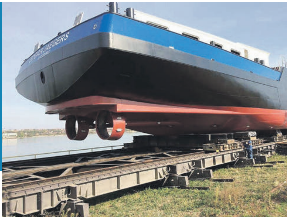
Ook het mts Edgar Jaegers is bij De Waal voorzien van een Stuwa besturings-systeem en schroefassen.
