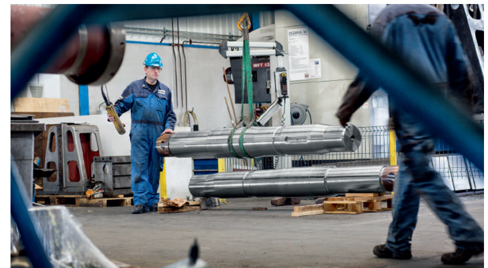
Machinale bewerkingen van roerkoningen en schroefassen in de werkplaats van De Waal.
