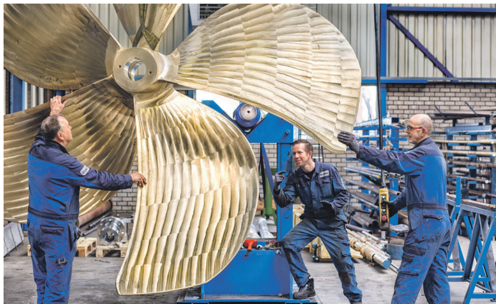
Het 'blauwen' van een schroef van een visserijkotter, op een schroefas van De Waal.
